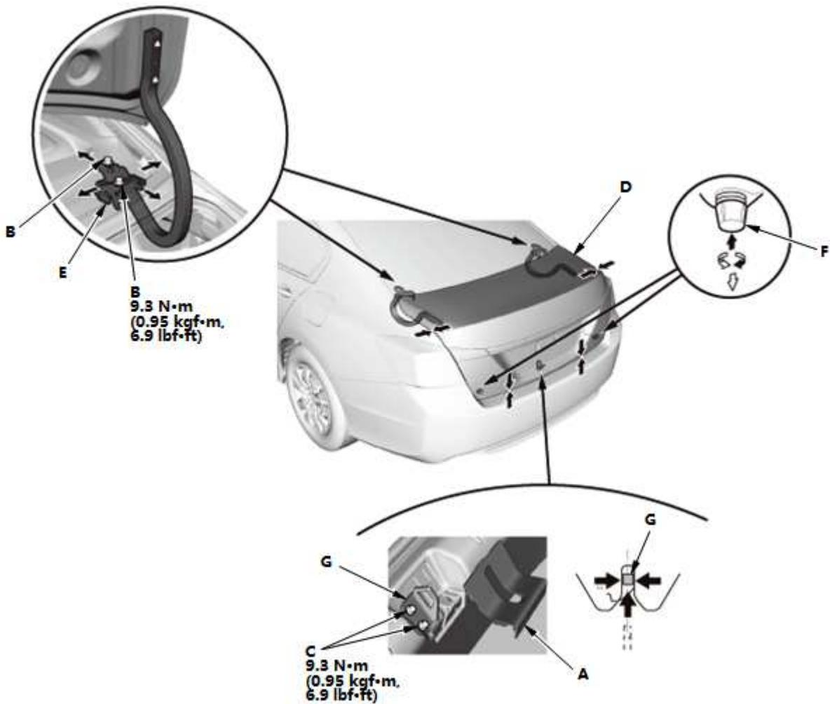
2. 稍微松开行李箱盖铰链螺栓 (B) 和锁扣螺栓 (C)。
